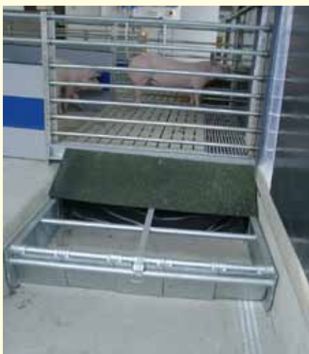
Abbildung 14: Emissionsarme Entmistung mit Schiebersystemen, auch ein mögliches EIP-Thema
