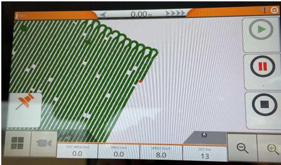
**Abbildung 9: GPS Datenaufzeichnung beim Säen**
