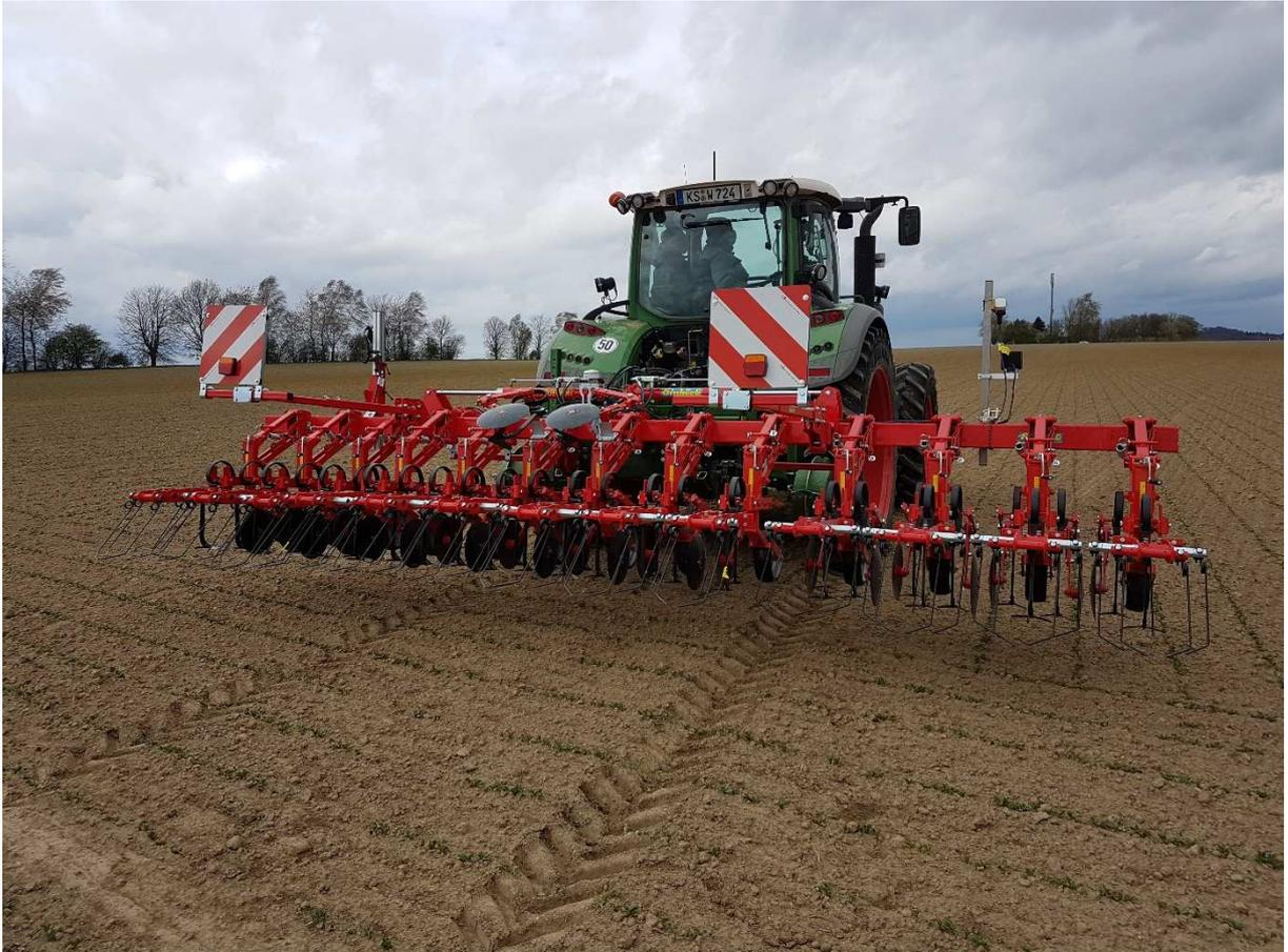
**Abbildung 11: Hackmaschine beim ersten Hackdurchgang**
