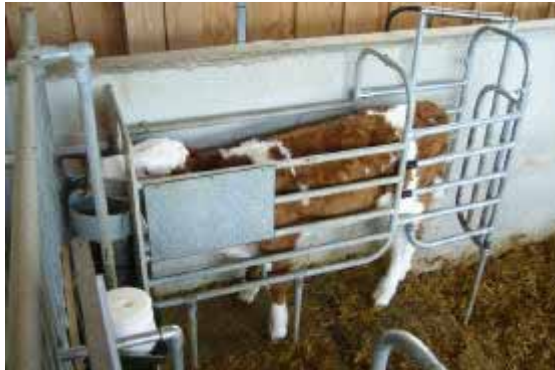
Bild 13: Tränkeautomat mit automatischer Tür und programmierbarer Verschlusszeit.
