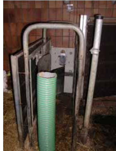
Bild 14: Tränkeautomat mit mechanischer Wippe zur Selbstbetätigung durch die Kälber.
