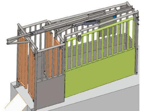
Abbildung 1: Skizze Neukonstruktion der KFS Lamking DoubleBox mit geänderten Merkmalen farbig markiert (Quelle: Wasserbauer)
