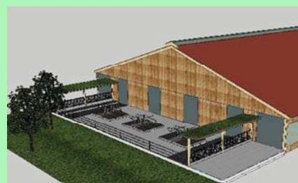
Strukturierung eines Laufhofes mit zusätzlichen, unüberdachten Liegeplätzen verringert die emittierende Fläche und ermöglicht eine Schieberentmischung des Auslaufes (Bildquelle: Eigene Darstellung).
