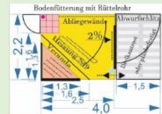
Abb. 1: KW-Bucht, ohne Auslauf mit innenliegendem Kotbereich
